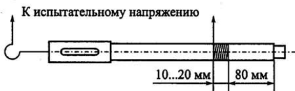
Рис. 10.3. Схема подключения напряжения при испытании рабочей части и определении напряжения зажигания указателя УВНИ-10
