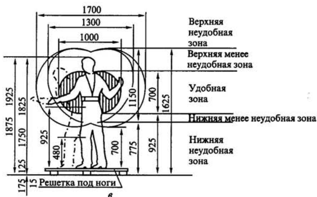
Рис. 4.2. Рабочие зоны в горизонтальной (а) и вертикальной (б) плоскостях, а также зоны досягаемости рук в горизонтальной плоскости при движении (в)
