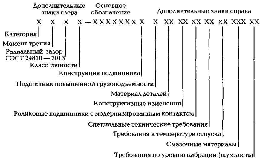
Рис. 2.9. Порядок и расположение дополнительных знаков маркировки подшипников
