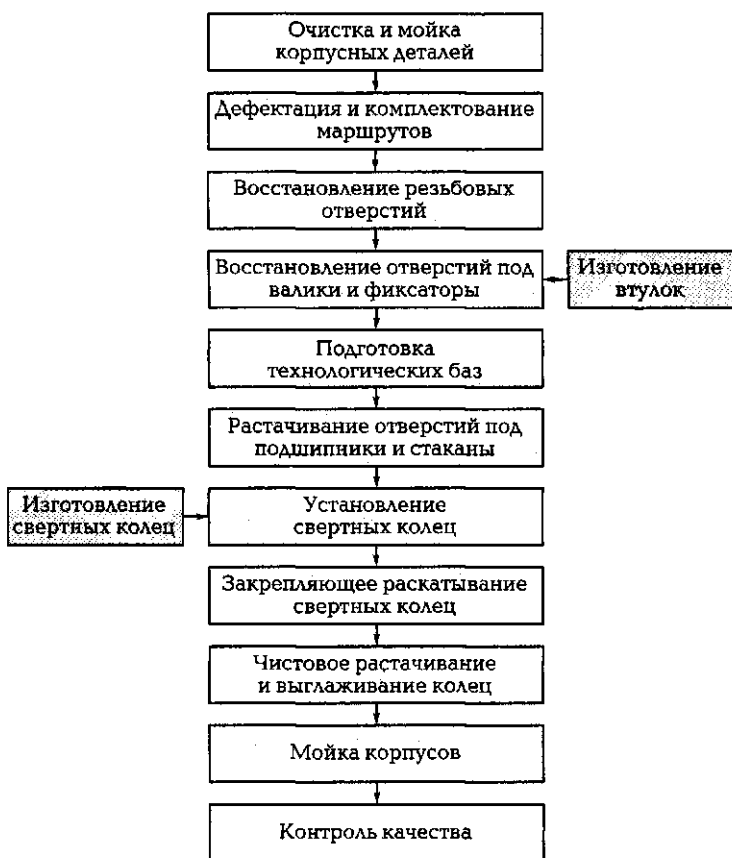
Рис. 1.8. Схема технологического процесса восстановления корпусных деталей
