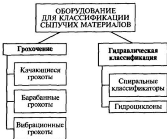
Рис. 5.1. Схема распределения видов оборудования для классификации сыпучих материалов по способам ее осуществления
