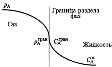
Рис. 3.2. Схема распределения парциального давления и концентрации растворимого газообразного вещества А по фазам при массопередаче
