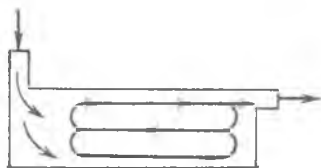
Рис 6.4. Зоны циркуляции в реакторе вытеснения
