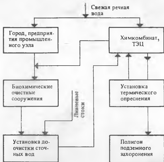
Рис. 12.9. Комплексная схема и баланс водопотребления Первомайского химического комбината
