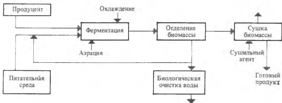
Рис. 18.1. Функциональная схема получения биомассы
