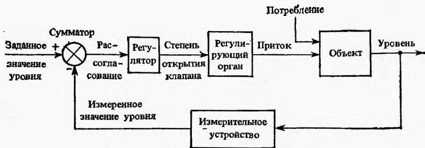
Рис. 4. Структурная схема АСР уровня в емкости.
