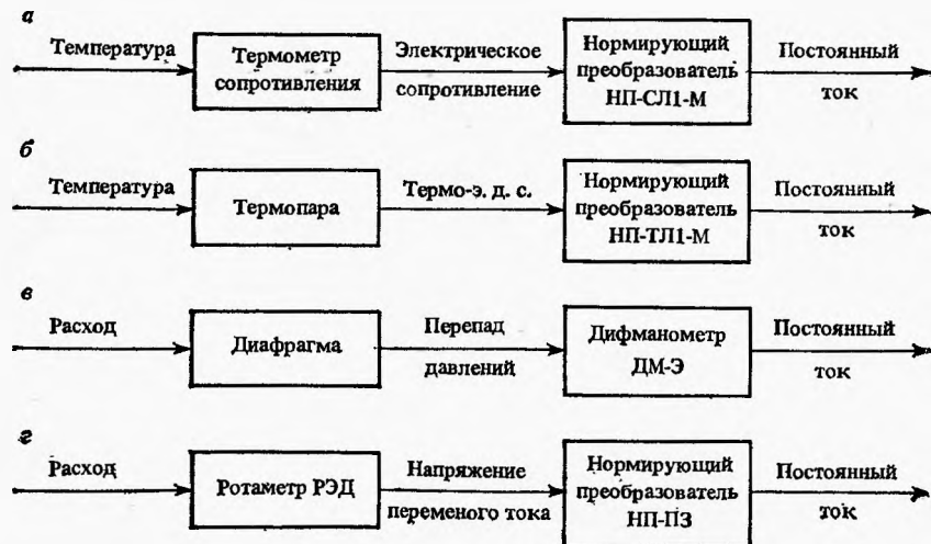
Рис. 125. Примеры измерительных цепей регулятора „Ремиконт“:
