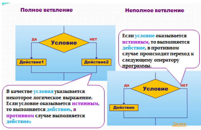
Рис. 3.2 Иллюстрация полного и неполного ветвлений
