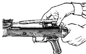
**Рис. 15.** Отделение затворной рамы с затвором
