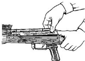
**Рис. 13.** Отделение крышки ствольной коробки
