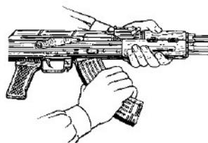
**Рис. 19.** Присоединение газовой трубки
