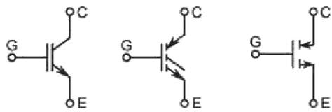
Условные графические обозначения IGBT-транзисторов, используемые различными производителями на принципиальных схемах электронных устройств
