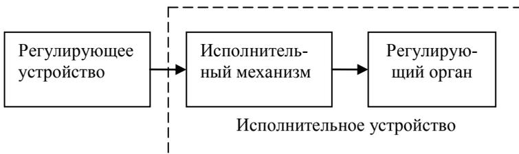
Рис. 1. Основные блоки исполнительного устройства
