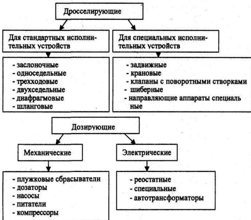
Дросселирующие регулирующие органы изменяют гидравлическое сопротивление в системе, воздействующее на расход вещества путем изменения своего проходного сечения. К ним относятся регулирующие клапаны, заслонки и шиберы.
